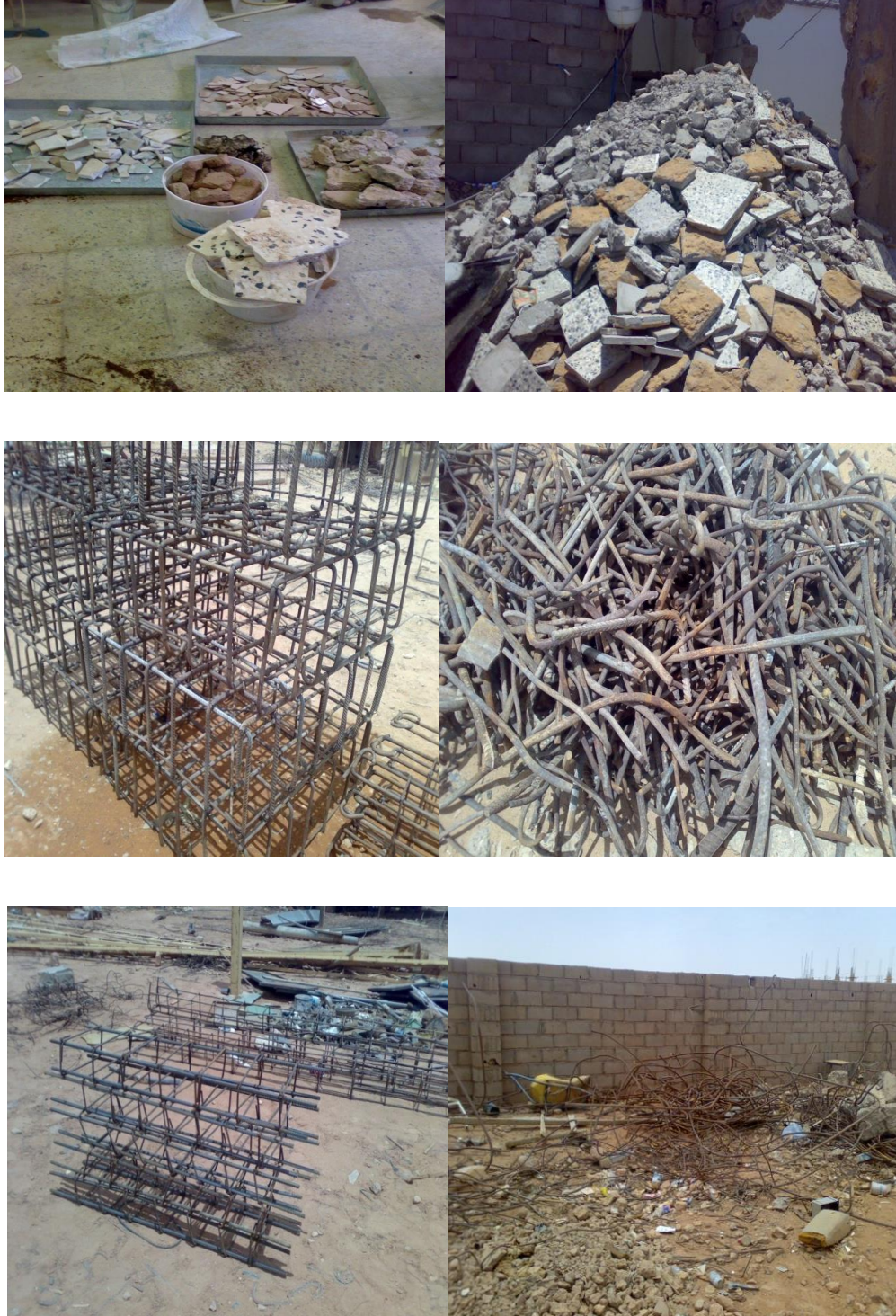
شكل (1) صور توضح حديد التسليح ناتج الهدم قبل وبعد إعادة التصنيع، والمواد الإنشائية ناتج الهدم المستخدمة للبحث
