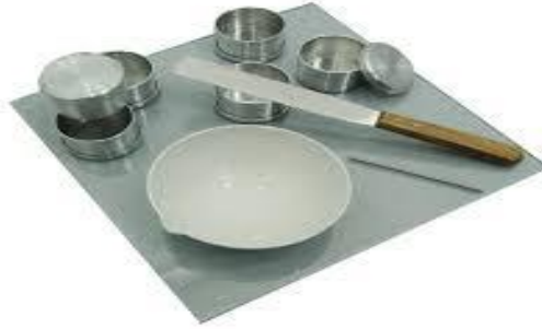
شكل (3) توضيح لبعض الأدوات المستخدمة في إختبار حد اللدونة
