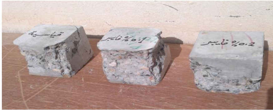
شكل 3: المكعبات بعد إجراء اختبار مقاومة الضغط
