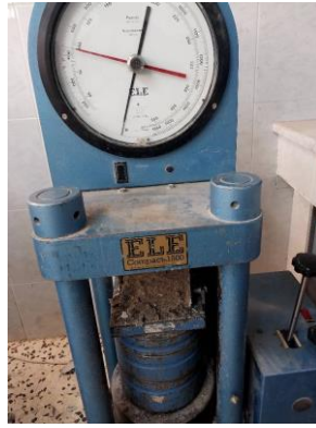
الشكل 4.3 يوضح اختبار عينة من خرسانة RCC لاختبار مقاومة الضغط داخل الجهاز
