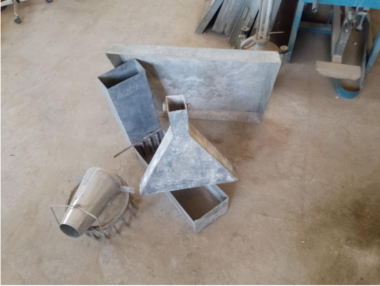
الشكل (1) صورة توضح معدات إختبار الخرسانة الذاتية الدمك -داخل معمل الخرسانة ومواد البناء كلية الهندسة جامعة وادي الشاطئ
