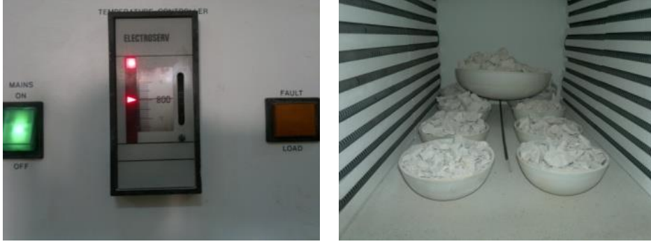
شكل (2): تنشيط البوزلانا المحلية بواسطة الحرق
