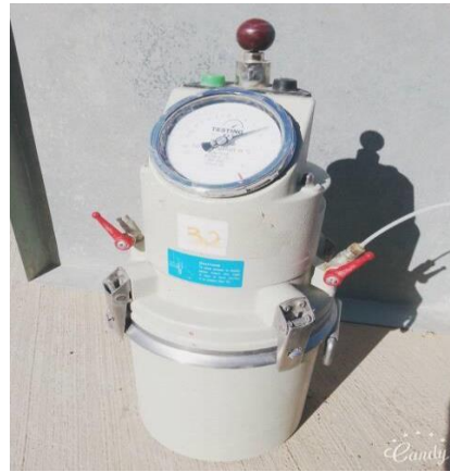
الشكل (5) الجهاز المستخدم في اختبار نسبة الفراغات الهوائية
