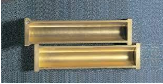
شكل (4) القالب المستخدم في اختبار الإنكماش الطولي لعينات التربة
