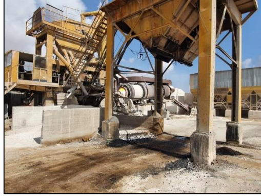
شكل (1) الخلاطة المركزية لإنتاج الخلطات الاسفلتية شكل (2) الخلاطة المستخدمة في الدراسة
