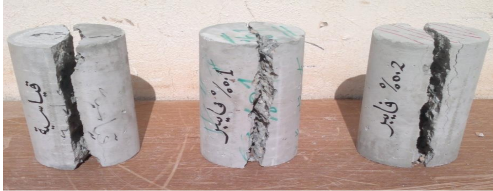
شكل 6: الاسطوانات بعد إجراء اختبار مقاومة الشد الغير المباشر
