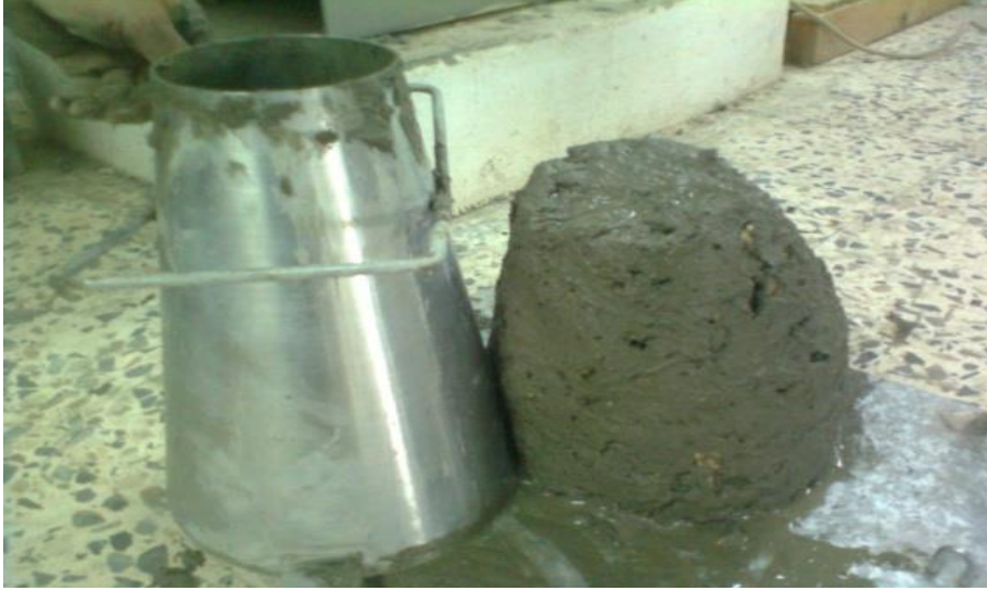
شكل 2: نتائج اختبار الهبوط للخرسانة الطازجة
