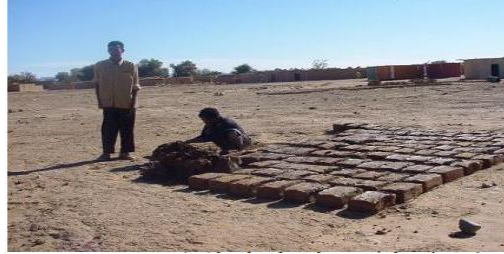
صورة (6) طريقة تجهيز الطوب الطيني وتجفيفه بأشعة الشمس [28]
