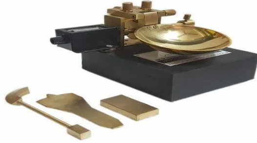
شكل (2) جهاز كاسغراندني لتحديد حد السيولة للتربة
