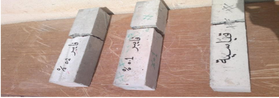
شكل 8 العينات بعد اجراء اختبار مقاومة الانحناء
