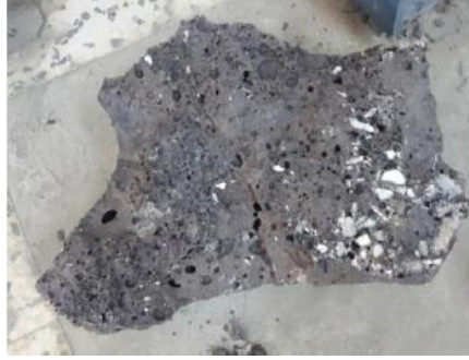
شكل 1: خبث أفران مصنع الحديد والصلب بحسب [5].
